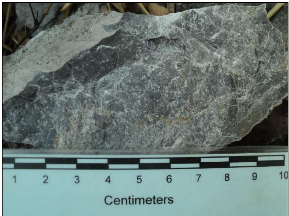
รูปที่ 2.8 แสดงเนื้อหินของหินปูนเนื้อโดโลไมต์ สีเทา เนื้อผลึก ของหน่วยหิน Pdlst
